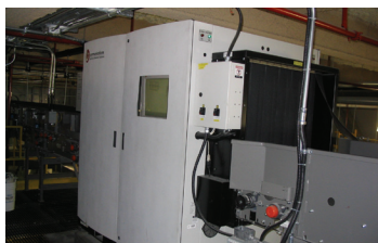
Figure 15 : Appareils de radioscopie VIS et VDS. L'appareil VIS108 est illustré à gauche alors que l'appareil VDS108 utilisé pour l'enregistrement des bagages surdimensionnés est illustré à droite.
